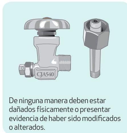
**3** No uses fuerza excesiva para apretar la tuerca, solo debes utilizar la herramienta que te dé el proveedor para ello.
