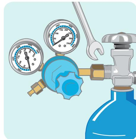
**4** Asegúrate que el tornillo de ajuste del regulador esté afuera.
